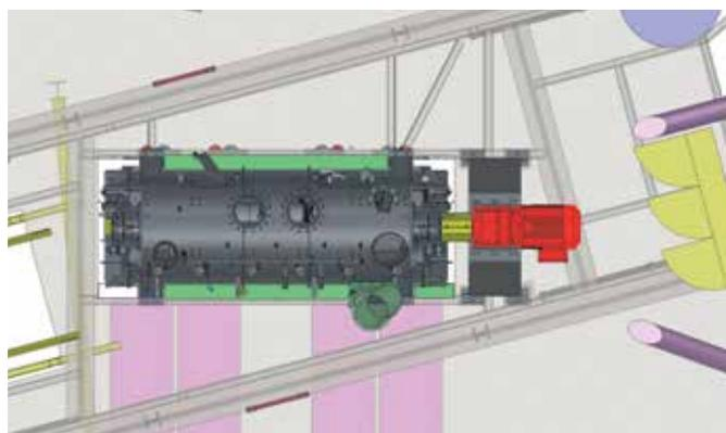
Configuration de l'installation après modification, avec un mélangeur SOFRADEN 'MIB VI'
