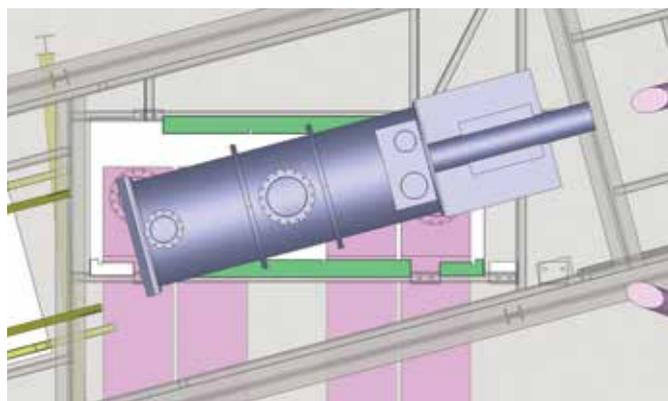
Configuration initiale de l'installation, avec un mélangeur à 2 clapets ponctuels de vidange
